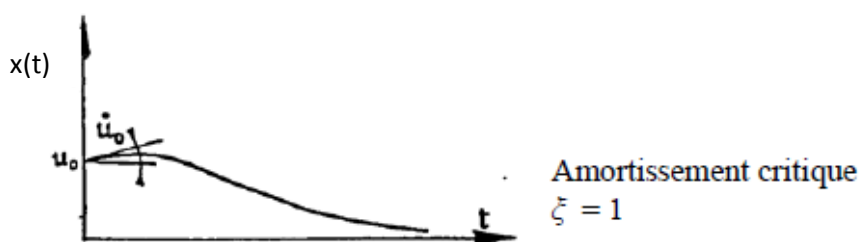
Figure 04 : Oscillation libre amortie (amortissement critique)
