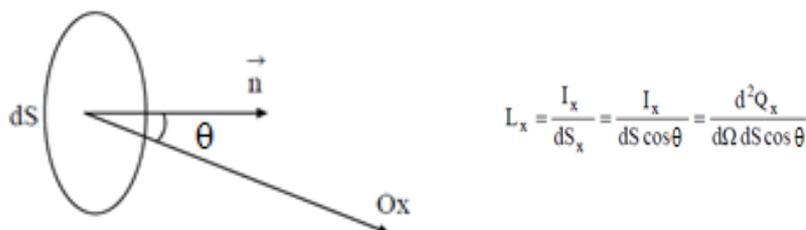
**Figure :** Schéma de définition des angles
