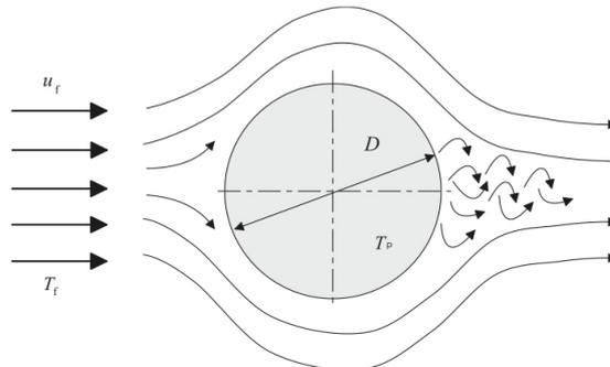
**Figure :** Écoulement autour d'un cylindre
