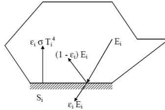
**Figure :** Schématisation des flux de rayonnement sur une surface
