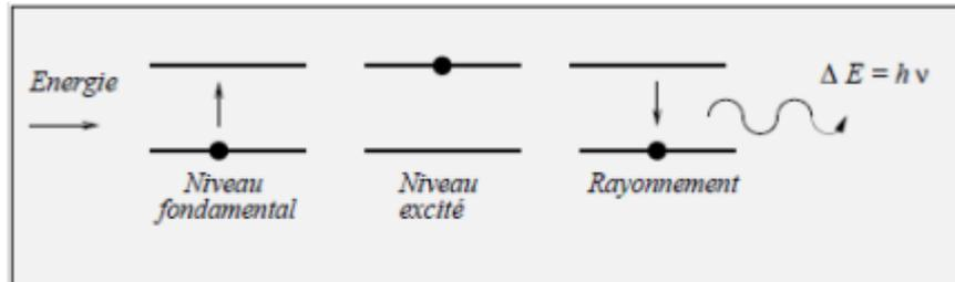
FIG. – Principe de l'émission d'un photon.
