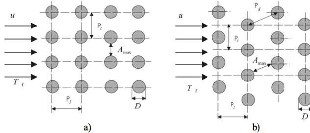
La disposition en quinconce conduit à de plus fortes turbulences et donc un coefficient d'échange plus important que pour un faisceau aligné. La corrélation utilisée est la suivante :
