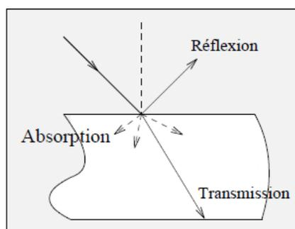
**Applications :** FIG. – Réflexion, transmission et absorption du rayonnement
