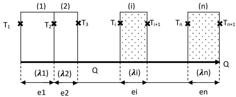
Mur 1 :  $T_1 - T_2 = Q \frac{e_1}{\lambda_1 A}$  Conduction dans plusieurs murs plans en série
