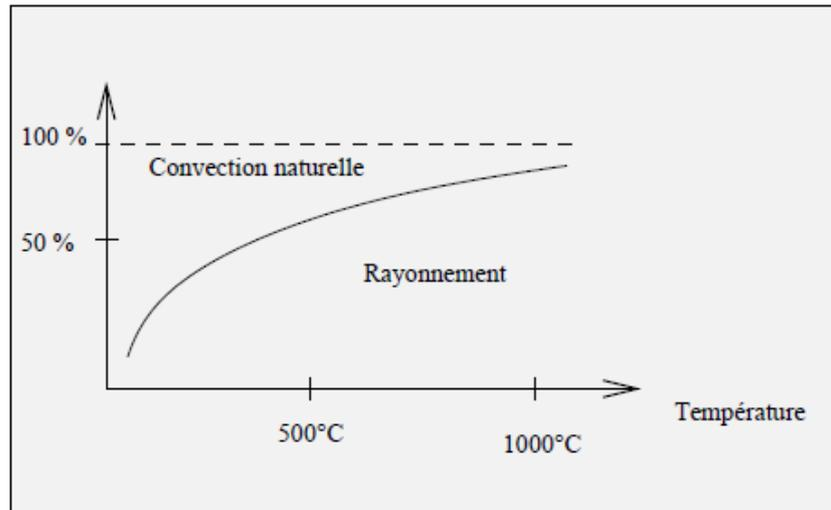
FIG.– Part relative du transfert par rayonnement en fonction de la température.
