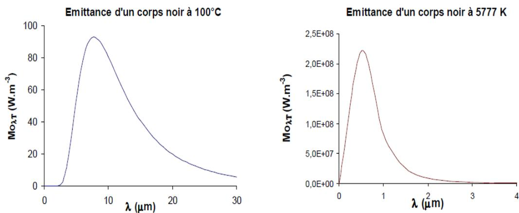
**Figure :** Emission monochromatique d'un corps noir à deux températures différentes
