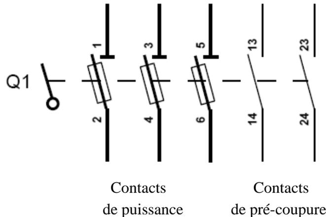
Le sectionneur ouvert, il n'y a plus de tension nulle part dans l'installation qui en dépend, sauf sur les bornes 1 , 3 , 5
