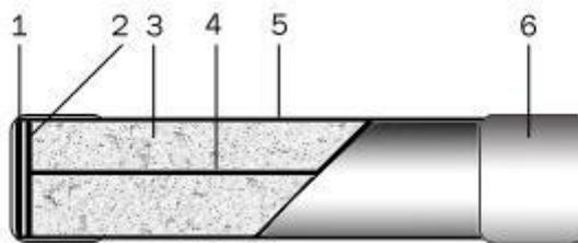
1 : Plaque de soudure ; 2 : Disque de centrage de la lame fusible ; 3 : Silice (permet une coupure franche) ; 4 : Lame fusible ; 5 : Tube isolant ; 6 : Embout de contact.
