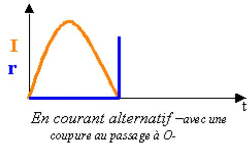
En réalité, au moment de la coupure, la résistance  $r$  des pôles du disjoncteur  $Q$  ci-dessus va passer d'une valeur presque nulle à une valeur très élevée, ce qui conduit aux graphes suivants :
