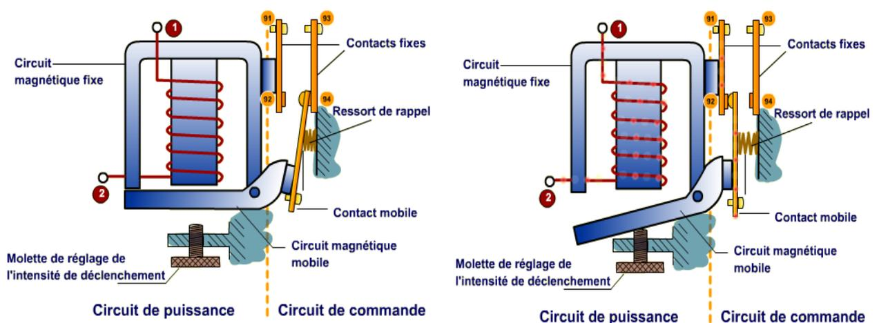
La raideur du ressort permet de régler pour quelle valeur du courant se produira la coupure. Le déclenchement est instantané avec un temps de réponse de l'ordre de milliseconde.
