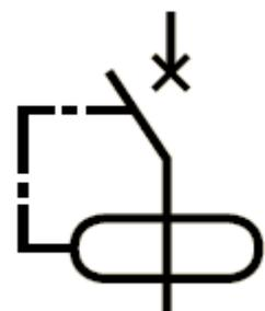
Dans une installation monophasée, si le courant dans le conducteur de phase au départ d'un circuit électrique est différent de celui du conducteur neutre, c'est qu'il y a une fuite. La différence d'intensité du courant à laquelle réagit un disjoncteur est appelée la "sensibilité différentielle du disjoncteur" (obligatoirement 30 mA sur les circuits terminaux domestiques), notée  $I\Delta n$  ("i delta n").
