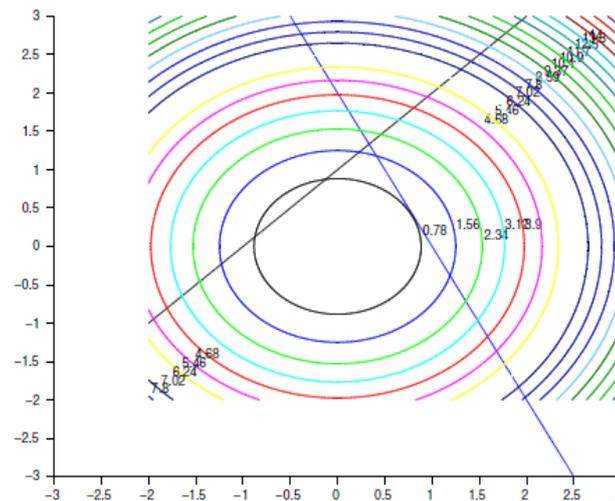
Elle représente les lignes de niveau de la fonction à minimiser et le domaine sur lequel on la minimise (quart de plan à droite). Le minimum correspond à un point qui est sur la droite de pente négative pour lequel la ligne de niveau est tangente à cette droite. On peut aussi le voir comme le point réalisant la distance de  $(0,0)$  à cette droite.
