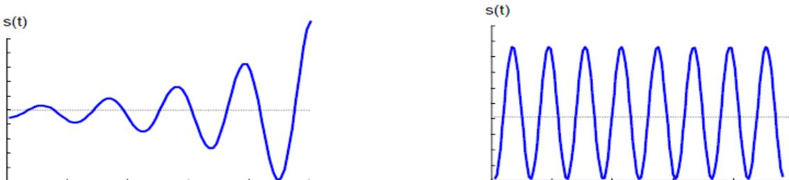
**Fig 5.3:** Système oscillatoire divergent (instable)
