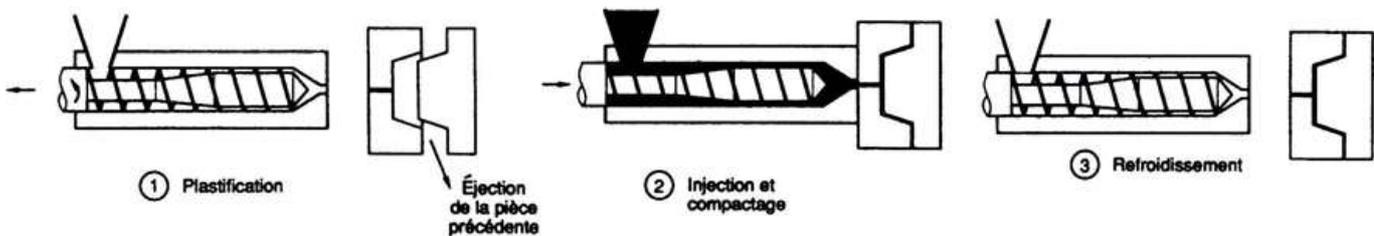
Figure 8 : Les différentes phases du cycle d'injection
