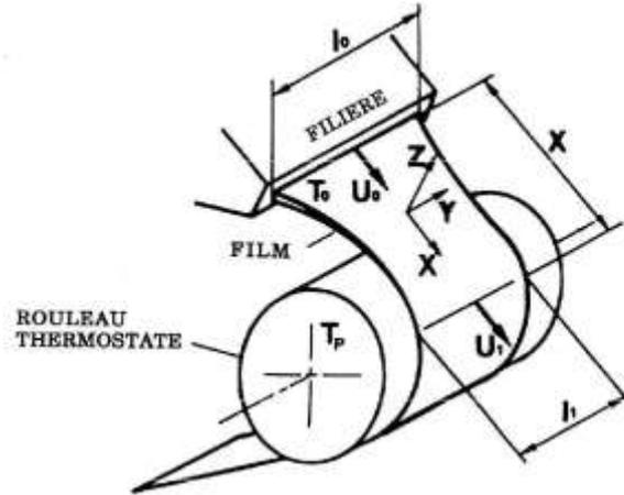
Figure 6 : Extrusion de film à plat ou procédé cast-film
