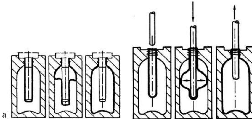
Figure 9 : Soufflage de corps creux : a) extrusion-soufflage ; b) injection-soufflage
