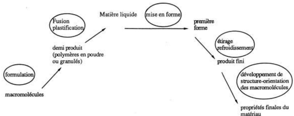
Figure 1 : Schéma général de la mise en œuvre des polymères thermoplastiques
