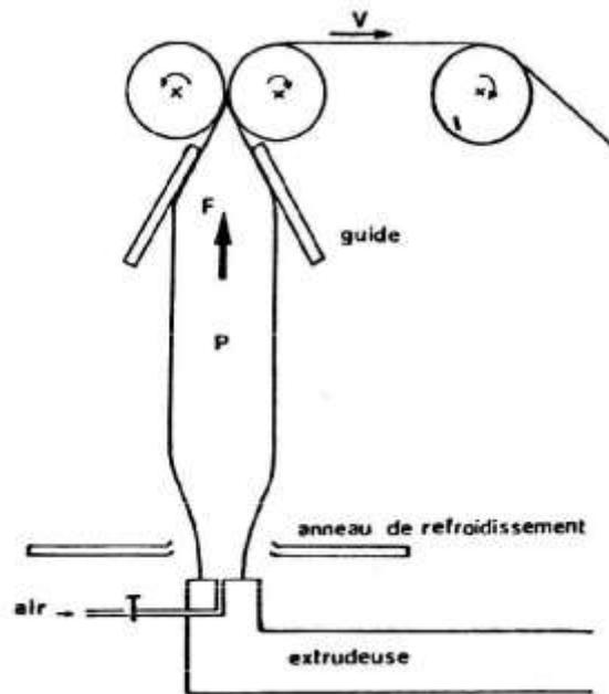
Figure 7 : Dispositif de soufflage de gaine
