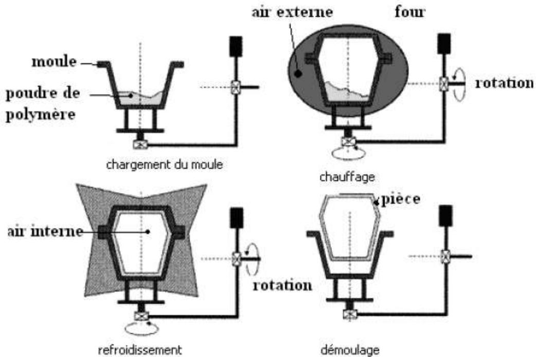
Principe de fonctionnement du rotomoulage : cas d'une pièce thermoplastique
