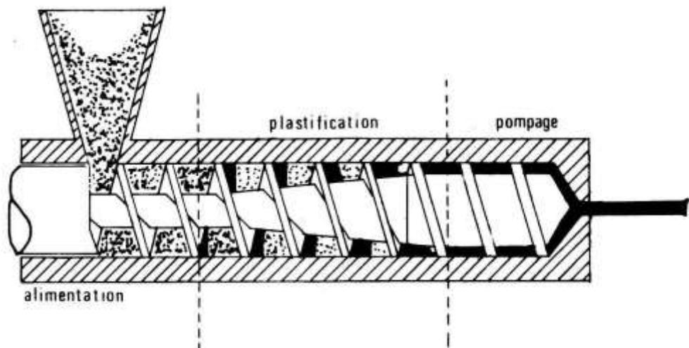
Figure 5 : Schéma de principe d'une extrudeuse monovis
