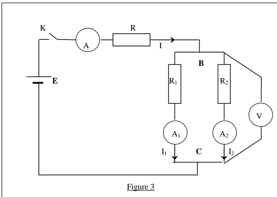
Réaliser le montage ci-dessus et relever les indications données par les trois ampèremètres et le voltmètre. Reporter ces indications dans le tableau ci-dessous.
