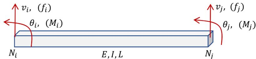
**Figure II.1.** Elément poutre et signe conventionnel de l'effort tranchant et moment fléchissant
