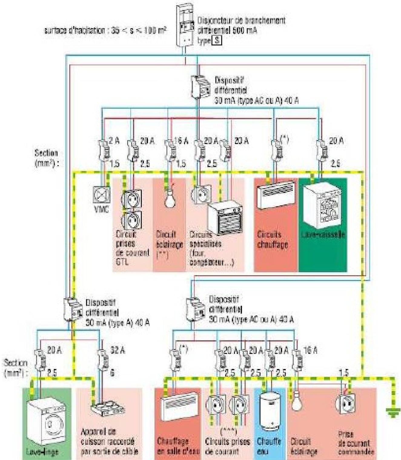
(\*) Section des conducteurs et courants assignés des disjoncteurs fonction de la puissance des convecteurs.
