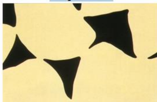
Figure 17 : Formation de « cous » de contact concaves contrastant avec la convexité des surfaces des particules
