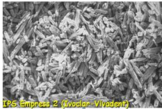
Figure 25 : microphotographie en microscopie électronique à balayage d'un échantillon de céramique alumineuse à haute teneur en particules cristallines et verre infiltré
