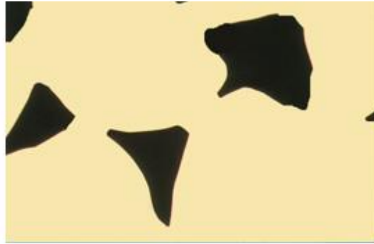
Figure 18 : Croissance des « cous » - Formation d'un réseau de pores interconnectés -Rapprochement du centre des particules (rétraction = 0,3%)
