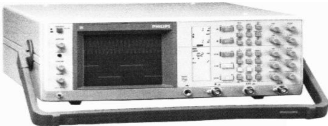
Ci-dessus, un modèle d'oscilloscope double traces. Il permet de mesurer des fréquences jusqu'à 60 [MHz] et ses commandes sont électroniques.
