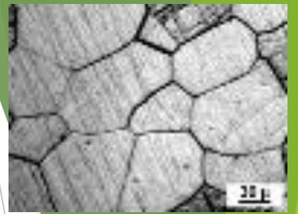
Microstructure d'un matériau polycristallin.
