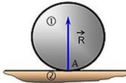
L'action mécanique de contact entre la bille et le plan est concentrée sur un point A et est schématisé par le vecteur  $\vec{R}$  ( $A_{2/1}$ ) perpendiculaire au plan de contact (2) et passant par le centre de gravité de la bille.
