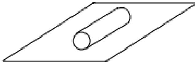
L'effort de contact est réparti de façon uniforme le long de AB est schématisé par une charge linéique  $q$  ( $N.m^{-1}$ ). On remplacera cette charge répartie par une action unique concentrée appliquée au milieu du segment AB telle que l'intensité :  $Q = q.L$ .
