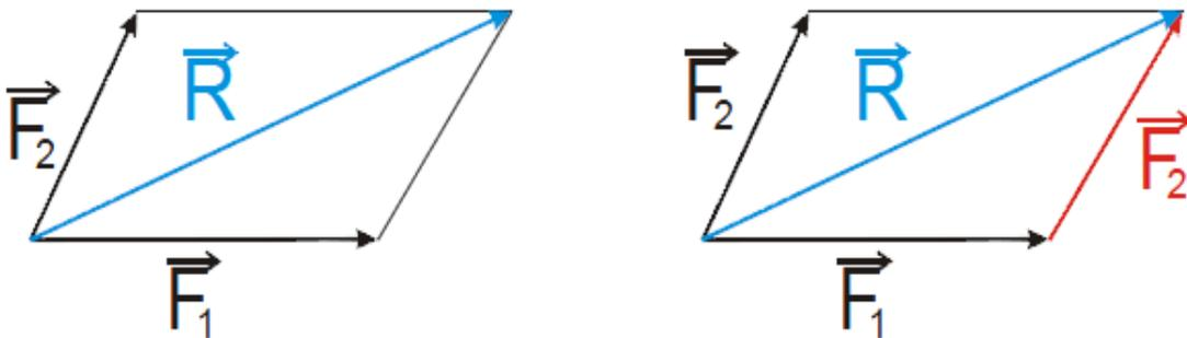
$\vec{R}$  s'obtient comme diagonale du parallélogramme construit sur  $\vec{F}_1$  et  $\vec{F}_2$  comme côtés.
