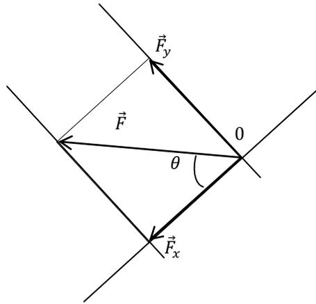
$F_x$  et  $F_y$  sont appelés les projections orthogonales de  $F$  sur les axes  $X$  et  $Y$ .
