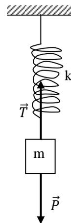
Fig.I-4. Système masse ressort
