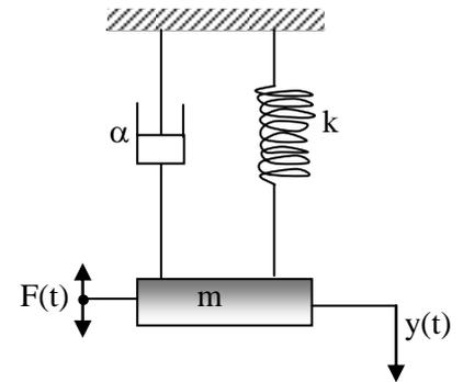
Fig. III-5. Oscillations forcées du système masse-ressort
