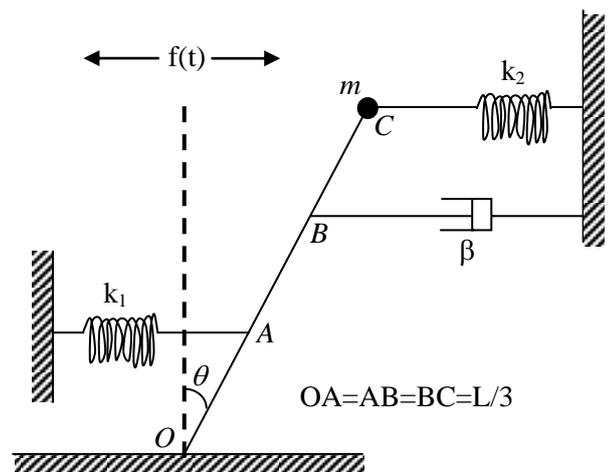
Fig. III-4. Oscillations forcées du système masse ressort
