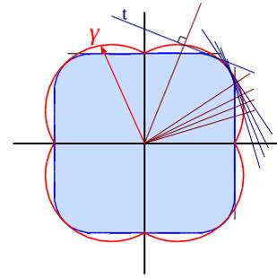
FIGURE 14.6 – La forme des cristaux et la construction de Wulff, ici à 2 dimensions. On trace d'abord, en coordonnées polaire, la courbe  $\gamma(\theta)$  (ici en rouge). A chaque point de la courbe, on trace une droite perpendiculaire à  $\gamma(\theta)$ . L'enveloppe de ces courbes (en bleu) est la forme du cristal. (source : wikipedia)
