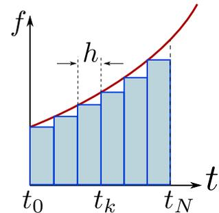
FIGURE 3.8 – L'intégrale  $I = \int_0^T f(t) dt$  peut être approximée par la somme  $S_N = \sum_{k=0}^{N-1} f(t_k)h$  où  $h = T/N$  et  $t_k = kh$ . Par définition,  $I = \lim_{N \rightarrow \infty} S_N$
