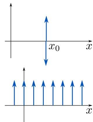
FIGURE 5.4 – La distribution  $\delta'(x - x_0)$  est souvent représentée par une double flèche positionnée en  $x_0$ . Si  $\delta(\cdot)$  représente une charge ponctuelle,  $\delta'(\cdot)$  représente un dipôle. Le peigne de Dirac est représenté par des flèches espacées de 1.
