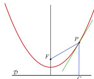
FIGURE 14.8 – Une parabole est définie comme le lieu des points à égale distance d'un point  $F$  (foyer) est d'une droite  $D$  (directrice). Soit un point  $P$  quelconque d'une parabole, et  $C$  un point de la droite tel que  $PC$  est orthogonale à  $D$  (par définition,  $FP = PC$ ); une des propriétés de la tangente en point  $P$  est qu'elle bissecte l'angle  $FPC$  et donc le segment  $FC$ . C'est pour cela qu'une parabole concentre la lumière parallèle en son foyer.
