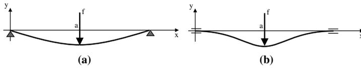
FIGURE 5.9 – la flèche d'un pont sous l'effet d'une force ponctuelle.
