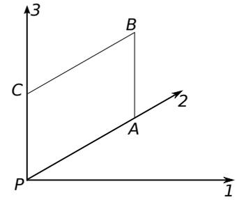
FIGURE 13.3 – un petit circuit autour du point  $P = (q_2, q_3)$ , où  $A = (q_2 + a, q_3)$ ,  $B = (q_2 + a, q_3 + b)$  et  $C = (q_2, q_3 + b)$ . Noter que le circuit est dans le plan  $(q_2, q_3)$  et perpendiculaire à l'axe  $q_1$ .
