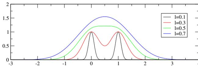
FIGURE 6.2 – La convolution du signal  $\delta(x) + \delta(x - 1)$  par des gaussiennes  $G_l$  de différente largeur.
