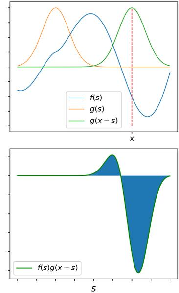
FIGURE 6.1 – Pour calculer le produit de convolution de fonction  $f()$  et  $g()$ , traduire la fonction  $g(s)$  de  $x$  et inverser la pour obtenir  $g(x - s)$  (figure haut). Multiplier  $f(s)$  par  $g(x - s)$  et intégrer sur  $s$  (figure bas). Pour chaque valeur de translation  $x$ , la valeur obtenue  $h(x)$  est le produit de convolution.
