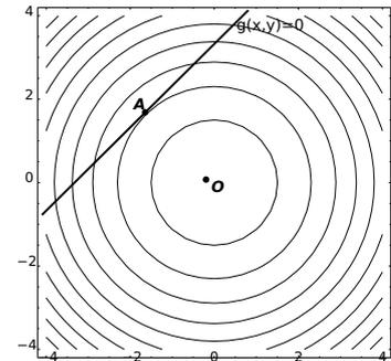
FIGURE 11.2 – La fonction  $f(x, y) = x^2 + y^2$  est représentée par ses courbes de niveau. Le minimum absolu de cette fonction est le point  $O = (0, 0)$ . Le point le "plus bas" de la fonction qui doit également appartenir à la courbe  $g(x, y) = 0$  est le point A.
