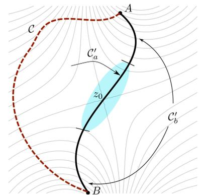
FIGURE 19.3 – La m thode du point col. Au lieu d'int grer sur le contour  $C$ , on int gre sur le contour  $C'$  qui passe par le point  $z_0$  ( $\phi'(z_0) = 0$ ) dans la direction de variation maximum de  $u(z)$  et qui laisse  $v(z)$  constant dans un voisinage du point  $z_0$ . Les courbes de niveau en trait fin sont celles de la fonction  $u(z)$ . L'int grale est domin e par la contribution de la portion  $C'_a$  du voisinage du point  $z_0$ .
