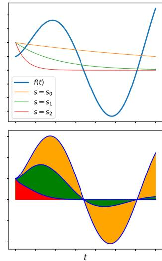
FIGURE 7.1 – Recette pour le calcul de la transformée de Laplace de la fonction  $f(t)$ . Figure haut : prenez la fonction  $f(t)$  et des exponentielles  $\exp(-st)$  avec différentes valeurs de  $s = s_0, s_1, s_2, \dots$  Figure bas : Multipliez la fonction par chacune de ces exponentielles, intégrez. Pour chaque valeur de  $s$ , l'intégrale vaut  $\tilde{f}(s)$ , votre transformée de Laplace.
