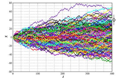
FIGURE 21.2 – Une simulation de  $M = 500$  trajectoires brownienne commençant en  $x = 0$  au temps  $t = 0$ . La probabilité  $P(x, t) dx$  de trouver la particule brownienne en  $[x, x + dx]$  au temps  $t$  est le nombre de trajectoire qui arrivent dans cet intervalle divisée par le nombre total de trajectoire, à la limite  $M \rightarrow \infty$ .
