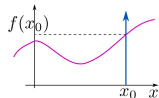
FIGURE 5.2 – La distribution  $\delta(x - x_0)$  "échantillonne" la fonction  $f(x)$  au point  $x_0$ .
