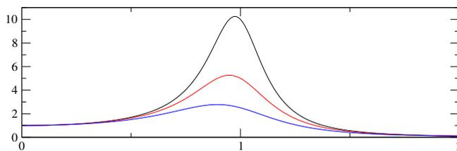
FIGURE 6.5 -  $|\tilde{x}(\omega)|^2$  (eq. 6.10) en fonction de  $\omega$  pour  $\omega_0 = 1$  et  $\nu = 0.1, 0.2, 0.4$ .
