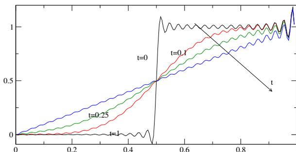
FIGURE 3.5 – Solution de l'équation de la chaleur par les séries de sinus avec  $L = 1$ ,  $u(0, t) = 0$ ;  $u(1, t) = 1$ , et condition initiale une fonction pallier. La solution est tracée pour 4 temps différents. Nous avons représenté la série par simplement ses 64 premières harmoniques. Notez les oscillations artificielles : les séries de sinus ont du mal à reproduire les discontinuités.
