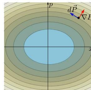
FIGURE 14.5 – En un point  $P$  de l'espace des phases, le mouvement infinitésimal  $d\vec{P}$  se fait perpendiculairement au gradient de l'Hamiltonien en ce point. Les courbes de niveaux sont ceux de l'Hamiltonien  $H(x, p)$ .
