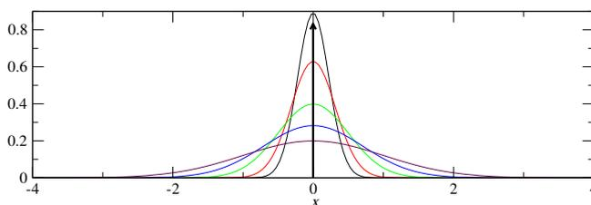
FIGURE 5.6 – profil de concentration en fonction de  $x$ , à différents temps  $t = 0.1, 0.2, 0.5, 1, 2$ . Ici,  $D = 1/4$ . La distribution originale, en  $\delta(x)$ , est représenté par une flèche verticale.
