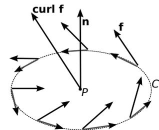
FIGURE 13.2 – Le champ  $\mathbf{f}$ , sa projection sur le circuit  $C$  entourant le point  $P$ , la normale à la surface  $\mathbf{n}$  et le rotationnel noté  $\nabla \times \mathbf{f}$  ou **curl**  $\mathbf{f}$ .
