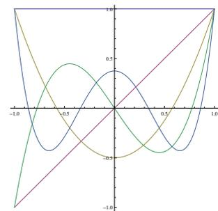
FIGURE 2.4 – Les polynômes de Legendre  $P_n(x)$  sur l'intervalle  $[-1, 1]$  et  $n = 0, 1, 2, 3, 4$ .  $P_n(\cdot)$  est un polynôme de degré  $n$ . Les  $P_n(\cdot)$  sont orthogonales les uns aux autres et forment une base de l'espace des fonctions (de carré sommable) sur l'intervalle  $[-1, 1]$ . (voir chapitre 12 )
