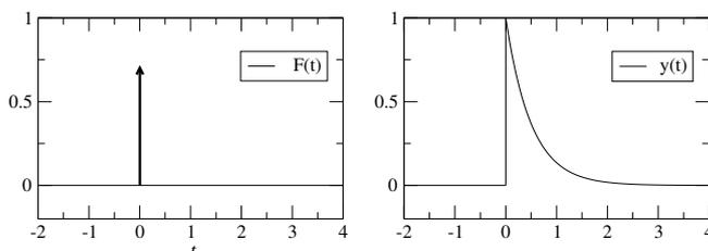
FIGURE 5.5 – Réponse d'un oscillateur amorti à une force impulsionnelle. La distribution  $\delta$  est représentée par une flèche verticale.
