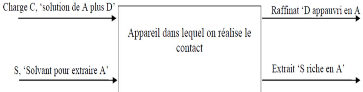
Schéma de principe d'une extraction liquide-liquide
