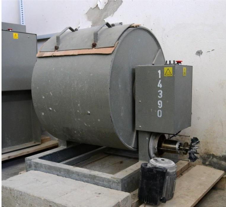
**Figure 1** : Cylindre pour l'essai de Los Angeles sur les graviers
