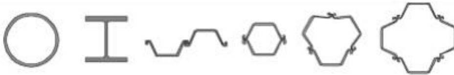
Fig. III 2 Profils métallique battus
