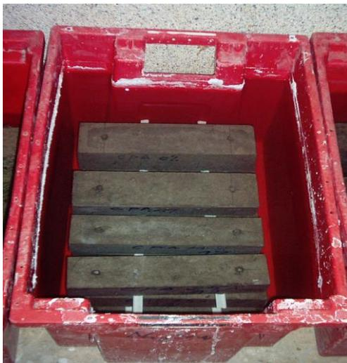
**Figure 2:** Immersion des éprouvettes dans la solution de sulfate de sodium (5% $Na_2SO_4$ ).
