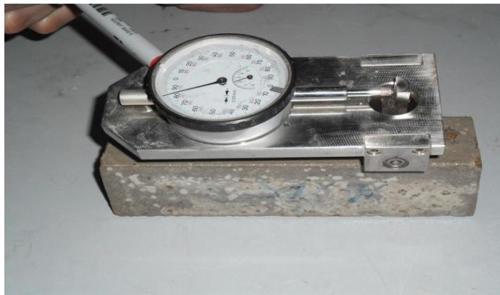
Figure 3: Appareil pour mesurer d'expansion des mortiers
