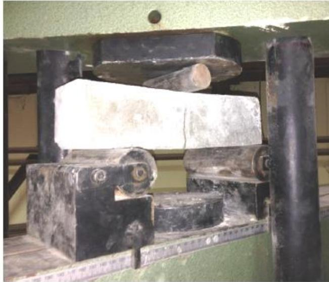
**Figure 2 :** *Essai de traction par flexion.*
