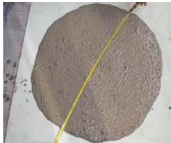
**Phot.** - Détermination de l'étalement.
