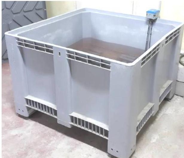
**Figure 3:** Bac d'eau pour la conservation des éprouvettes.
