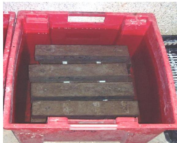
**Figure1:** Immersion des éprouvettes dans la solution de sulfate de magnésium (5% $MgSO_4$ ).
