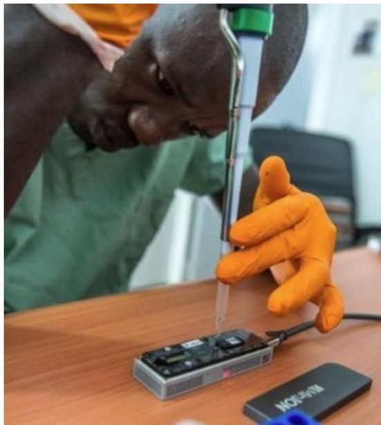
le séquenceur ultra-portable MinION (*Oxford nanopore technology*) - dit de 3<sup>e</sup> génération - a été utilisé en temps réel sur le terrain lors de la crise Ebola de 2015 et de la crise Zika en 2016 (Quick et al., 2016).
