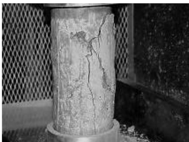
*Exemple d'essai de compression d'une poutre de béton*
