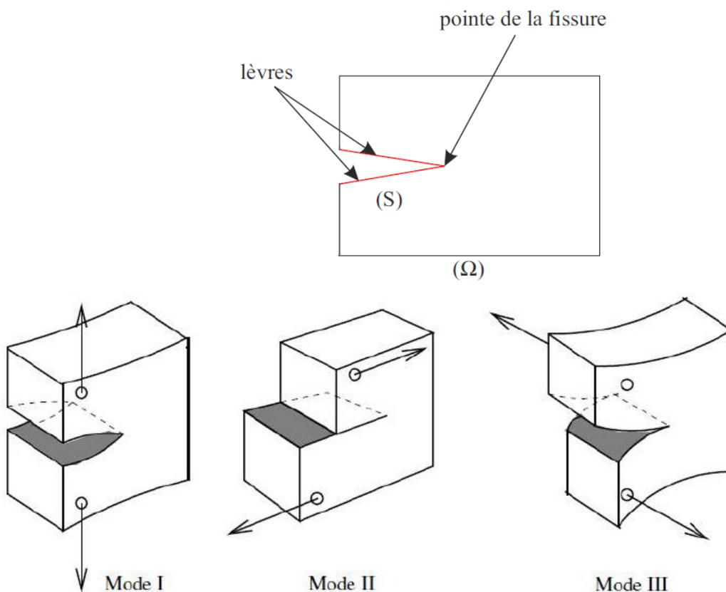
Mode I : ouverture (ou clivage), les surfaces de la fissure se déplacent perpendiculairement au plan de fissure ;
