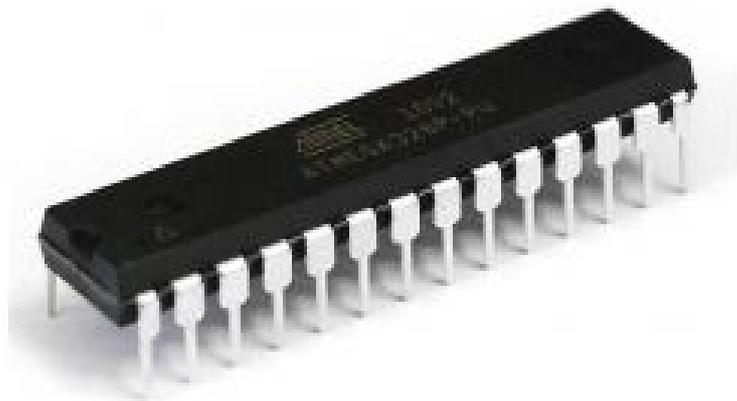
Un **microcontrôleur** (en notation abrégée **µc**, ou **uc** ou encore **MCU** en anglais) est un circuit intégré qui rassemble les éléments essentiels d'un ordinateur : processeur, mémoires (mémoire
