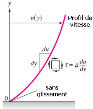
**Fig. 1 :** Couche limite d'un fluide visqueux près d'une paroi solide
