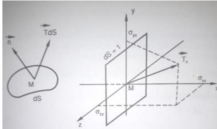
**Fig. 6 :** Tension sur un élément de surface  $\perp$  à la direction x
