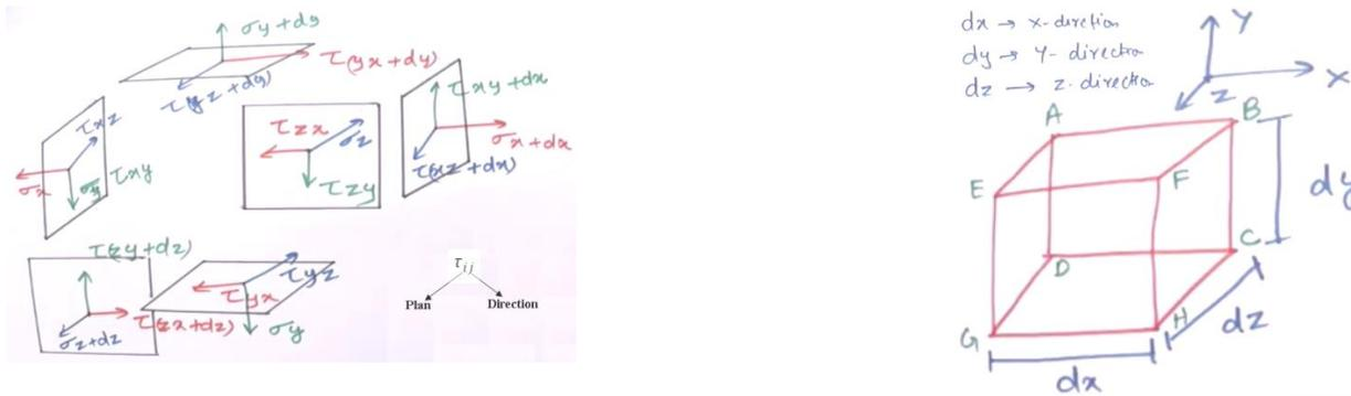
**Fig. 4 :** Notations utilisées pour les tenseurs des contraintes
