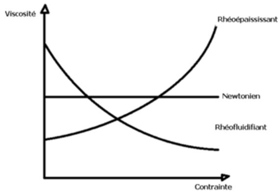
**Fig. 7 :** Courbes théoriques de la viscosité de plusieurs types de fluides en fonction de la contrainte de cisaillement
