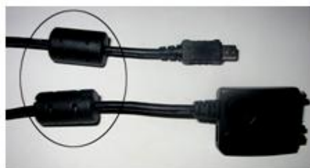
Ferrites utilisées pour réduire les parasites électromagnétiques
