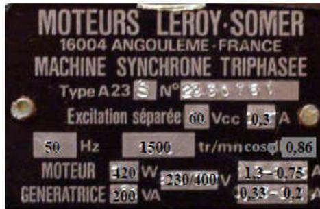
Figure 3.16. Exemple d'une plaque signalétique d'un moteur synchrone .
