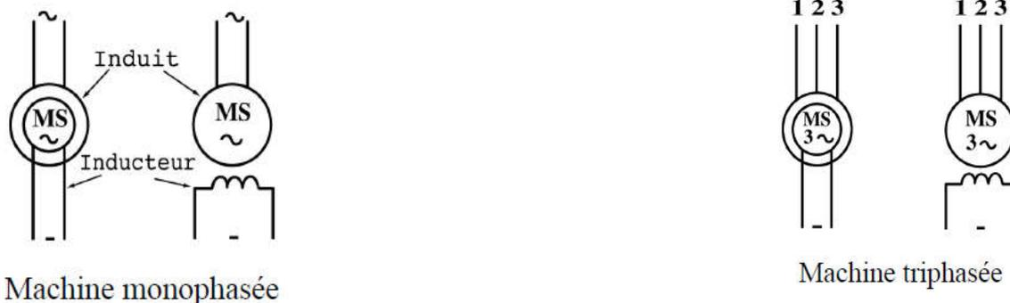
Figure 3.15. Symbole d'une machine synchrone.
