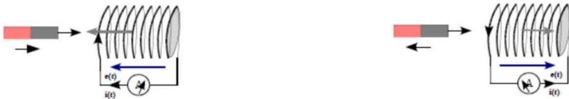
**Figure 2.8.** Illustration de la loi de Lenz magnétique uniforme.
