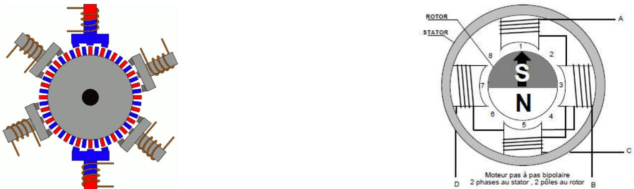
**Figure 2.19.** Constitution d'un moteur pas à pas.
