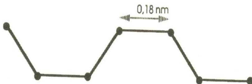
Figure I-16 : Structure en chaînes (S ∞ ) du soufre « mou ».
