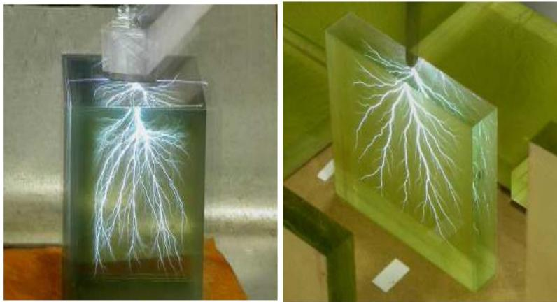
**Figure.7 :** Claquage d'un isolant
