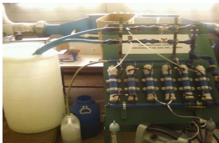
**Figure. 27 :** Système de traitement de l'eau par ozone
