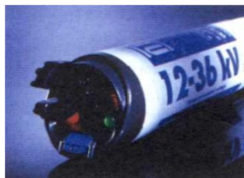
Figure VII.15 : Vérificateur d'absence de tension pour HT A
