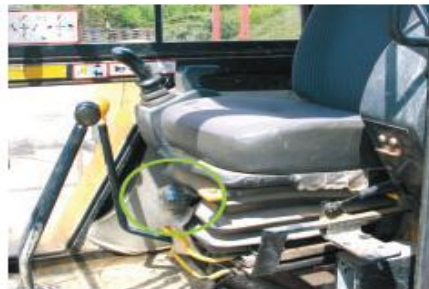
Figure IX.9 : Réduction des vibrations par réglage du siège
