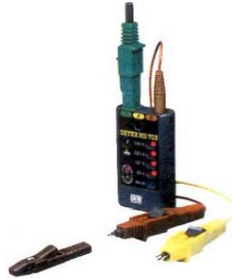
Figure VII.14 : Vérificateur d'absence de tension en BT
