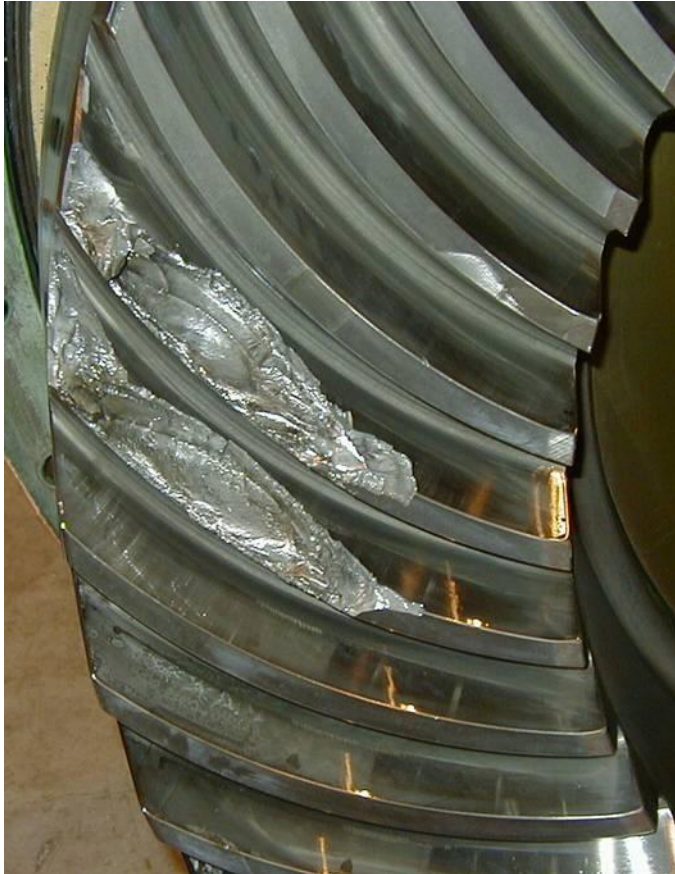
Arrachement de la matière dans un engrenage
