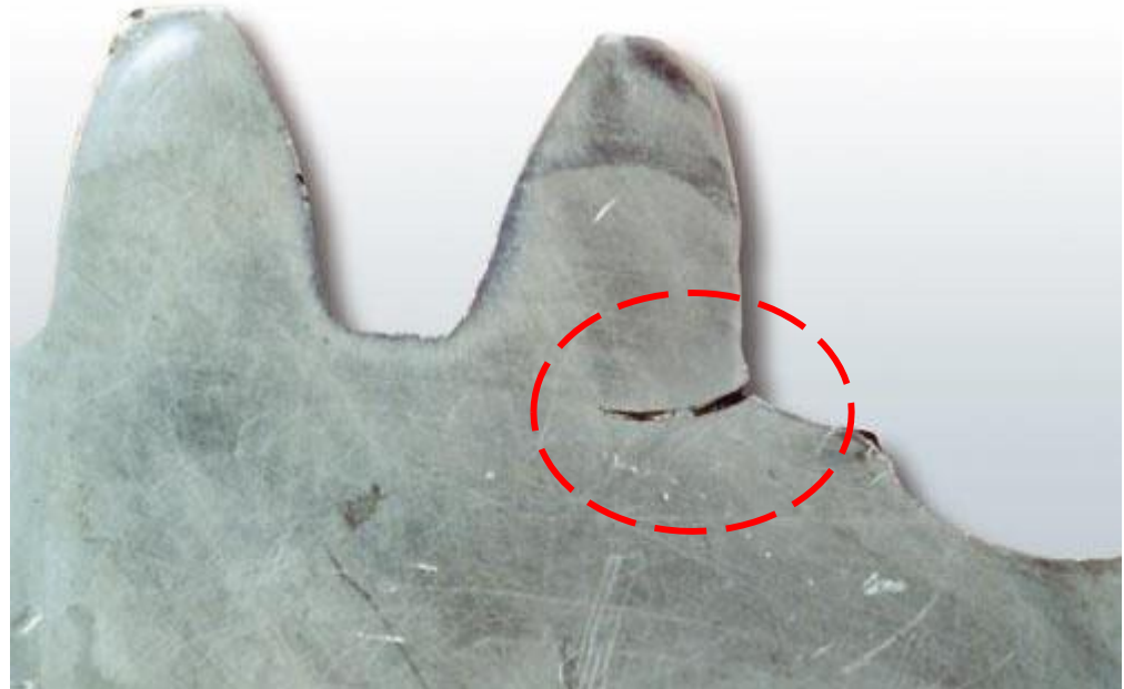
Propagation d'une fissure par fatigue à la base d'une dent d'engrenage
