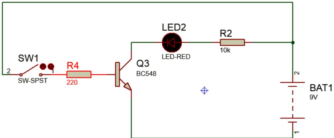
Figure 1: schéma de principe de base
