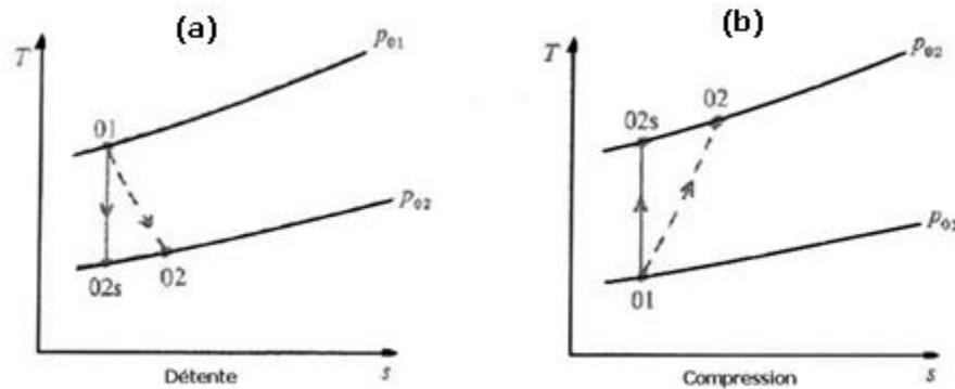
**Fig. 4 :** Diagrammes T-S pour l'écoulement adiabatique à travers une turbine (a) et un compresseur (b)
