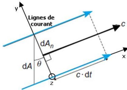
Fig. 1 : L'écoulement à travers un élément de contrôle
