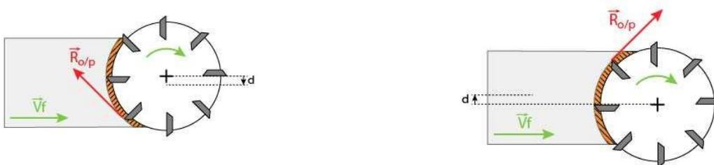
surface à réaliser est perpendiculaire à l'axe de la fraise. Comme pour le fraisage en roulant, le fraisage en bout peut être réalisé en opposition ou en avalant.
