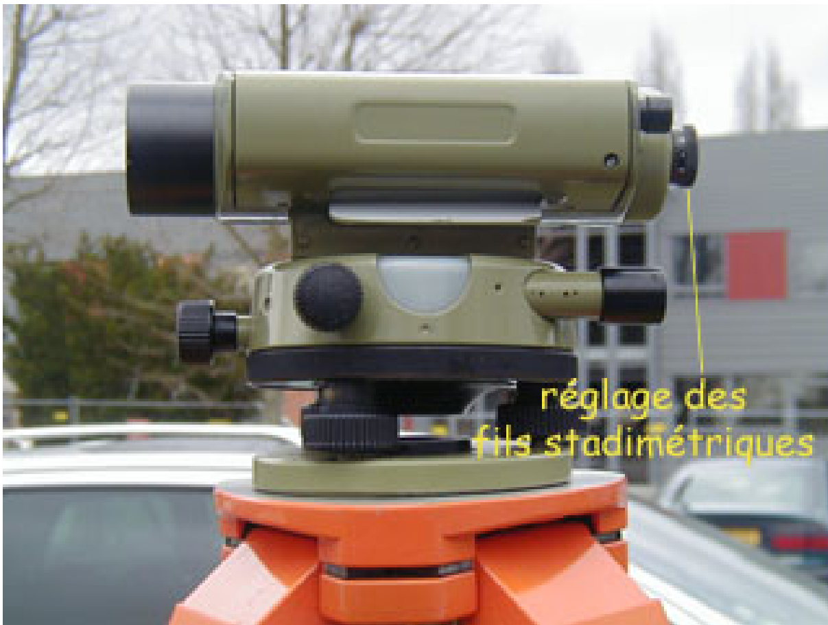
▲ IMG. 29 : MISE AU POINT DU RÉTICULE
