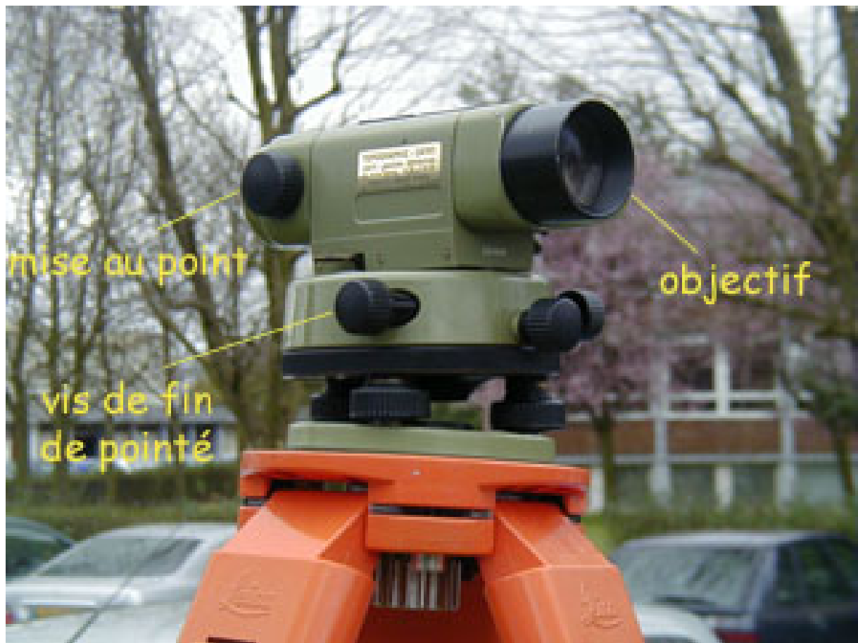
▲ IMG. 30 : MISE AU POINT DE L'IMAGE
