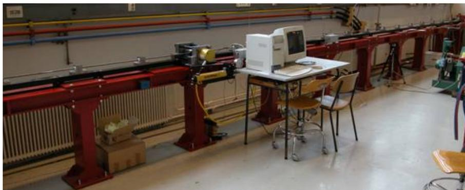
Fig. 2.11: Dispositif expérimental d'essai Hopkinson, NTNU, Trondheim (Norvège).
