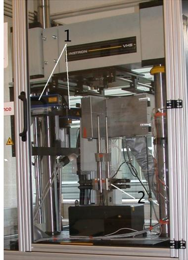
Fig. 2.7: Dispositif de traction grande vitesse (TGV) du CdM. 1) Cellules laser à effet Doppler pour la mesure de déformation 2) Dispositif de mors enserrant l'éprouvette "à la volée" lorsque la vitesse de déplacement désirée est atteinte. La vitesse de déplacement maximale de la traverse est de 25 m/s, la charge maximale de 80 kN, l'énergie d'environ 6 kJ; il est possible de réaliser des essais en température, entre -135 et +250 °C. (crédit photo : B. Tanguy, ENSMP, CdM)
