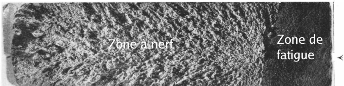
Fig. 5.1: Fracture d'un tirant d'assemblage de rotor d'alternateur amorcé (à droite) au niveau de la flèche par une fissure de fatigue ayant amené la rupture fragile, caractérisée par l'aspect de chevrons (à gauche) (tiré de [CPRJ69]).
