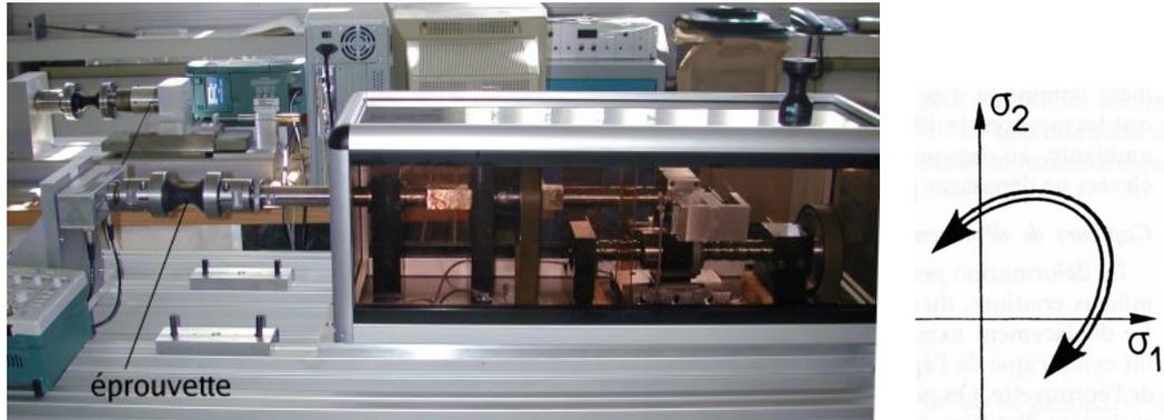
Fig. 3.2: Photo de gauche : dispositif de traction-torsion du Centre des Matériaux, image de droite : chemin mécanique pouvant être appliqué sur une éprouvette lors d'essais de traction torsion (tiré de [LC])
