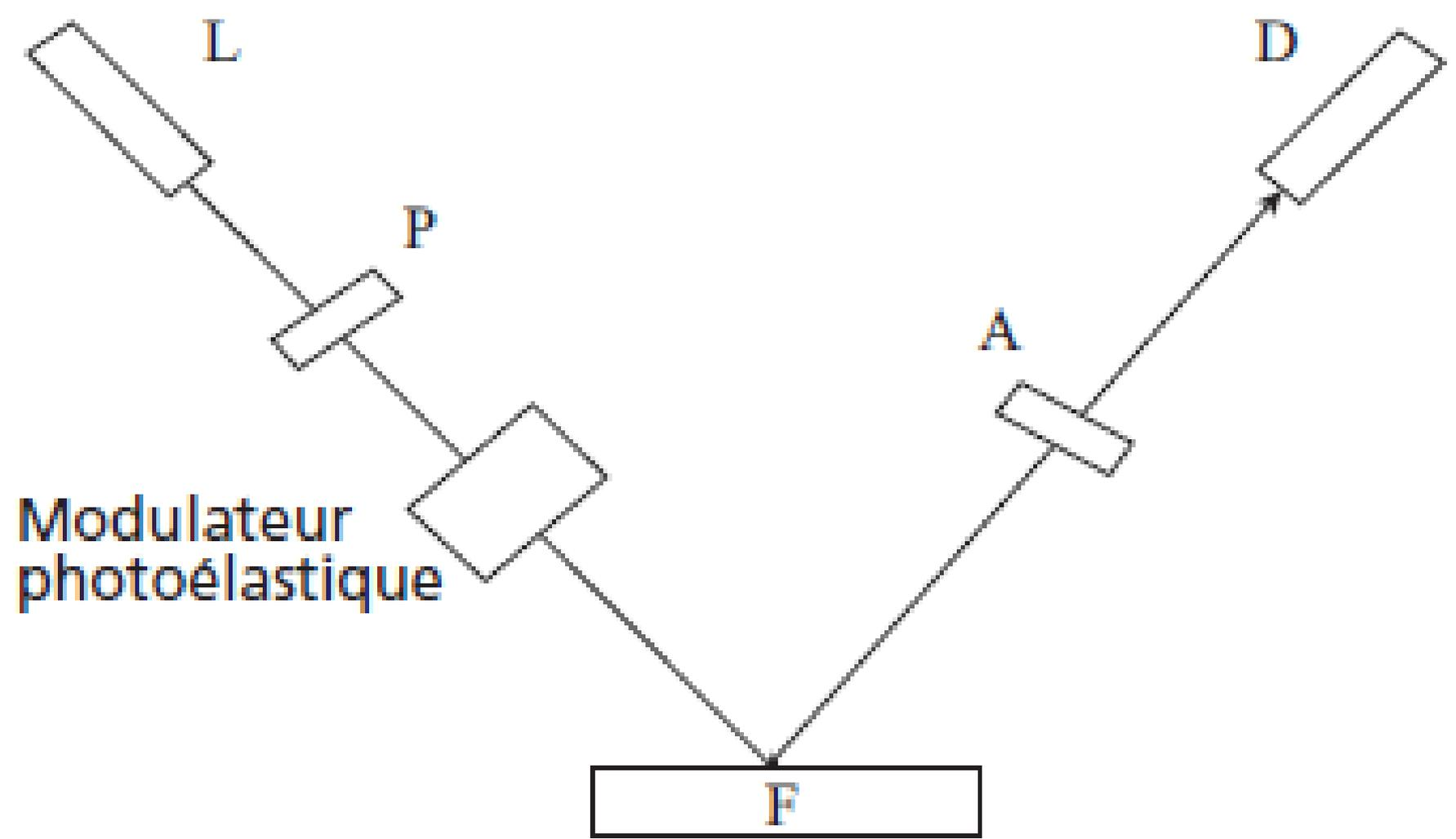
L'avantage de cette technique est que toutes les composantes optiques sont fixes durant les mesures, ce qui nous affranchit des problèmes de fluctuations mécaniques. De plus, la fréquence de modulation étant typiquement de 50 kHz, elle permet d'éviter les perturbations par les bruits habituels. La fréquence de modulation de 50kHz permet des mesures très rapides.
