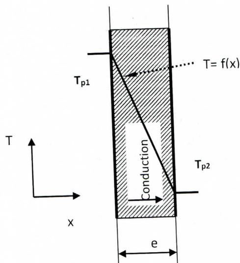
Figure III.1 : Température le long d'un mur homogène et isotrope
