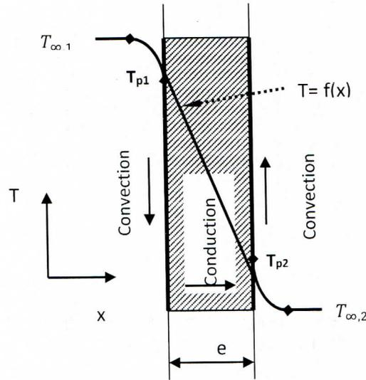
Figure III.2 : Température le long d'un mur homogène et isotrope (Transfert convectif-conductif-convectif)
