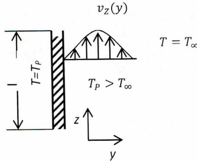
Figure III.3 : Exemple de convection naturelle
