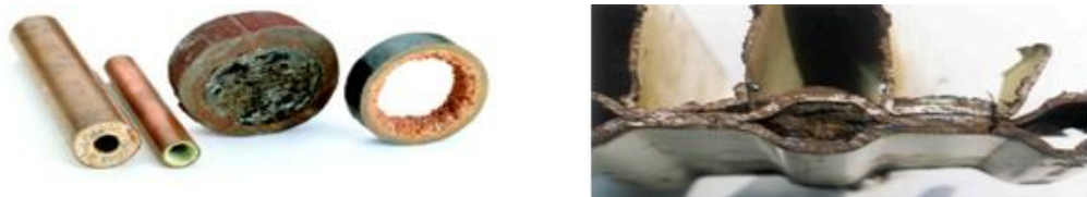
Figure III.3 : Les problèmes typiques sur les réseaux de chauffage
