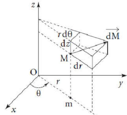
**figure 4:** volume et surfaces élémentaires en coordonnées cylindriques.
