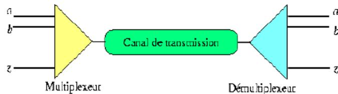
Le multiplexage consiste à faire transiter sur une seule et même ligne de liaison, dite voie haute vitesse, des communications appartenant à plusieurs paires d'équipements émetteurs et récepteurs comme représenté dans la figure:
