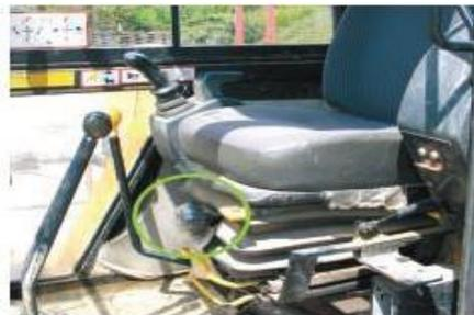
Figure IX.9 : Réduction des vibrations par réglage du siège
