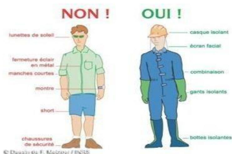
Figure VI.13 : La tenue réglementaire d'un opérateur électrique
