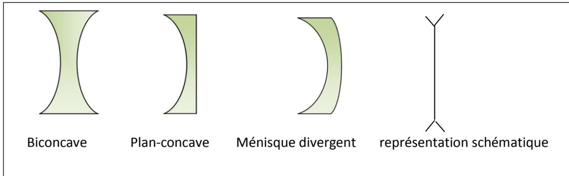
➤ on supposera que les deux sommets des deux calottes sont confondus en un point O appelé centre optique de la lentille. Tout rayon passant par le centre optique traverse la lentille sans déviation.
