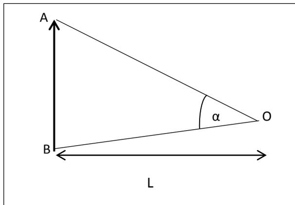
Le diamètre apparent est  $\alpha \approx \text{tga} = \frac{AB}{L}$
