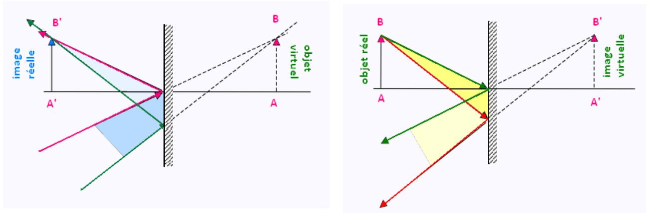
Les deux figures ci-dessus montrent la construction d'image par un miroir plan, en vertu de la loi de réflexion. De ces deux figures on peut généraliser sur la nature de l'objet et celle de l'image comme suit ;
