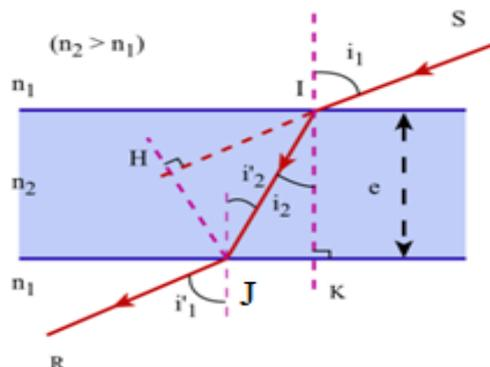
1) Marche d'un rayon lumineux à travers une lame à faces parallèles d'épaisseur « e ».
