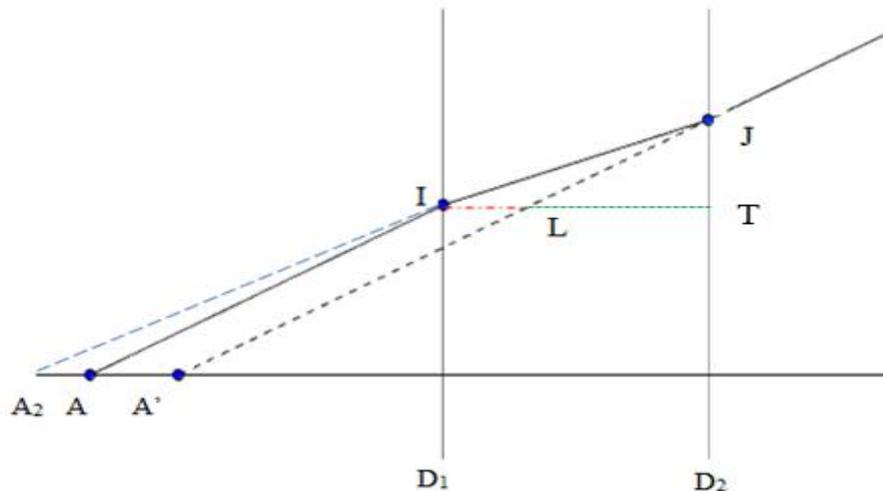
Le rapprochement de l'objet A est  $AA'$  tel que  $AA' = IL$ . Or IL est le rapprochement apparent que fait subir le dioptré  $D_2$  à un point objet situé en I, à la distance  $IT=e$  de son plan.
