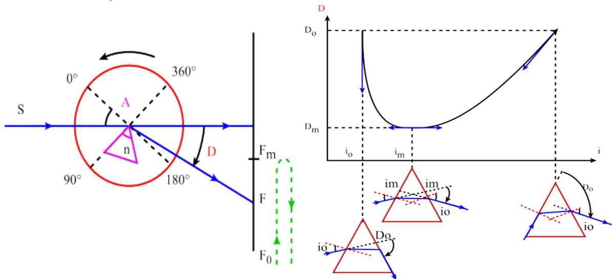
On montre qu'au minimum de la déviation, l'angle d'émergence est égal à l'angle d'incidence:
