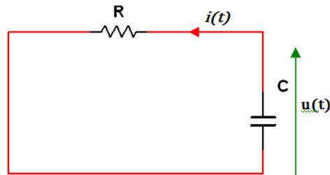
Figure 4: Décharge d'un condensateur
