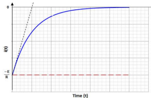
Figure 6 : Intensité aux bornes du Condensateur
