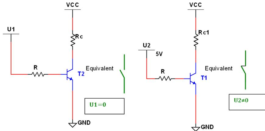
Dans un transistor utilisé comme commutateur (figure7), la section émetteur collecteur est utilisée comme contact et la section base émetteur représente la partie de commande. Le circuit de commutation et le circuit de commande ne sont pas galvaniquement séparés. Le transistor en conduction correspond à l'interrupteur fermé, le transistor bloqué à l'interrupteur ouvert.
