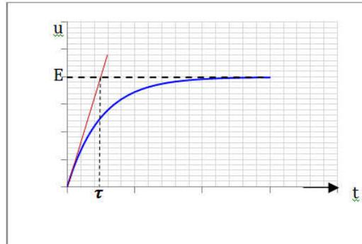
Figure2- Tension aux bornes du condensateur
