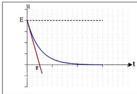
Figure. 5 : Tension aux bornes du condensateur
