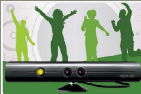
Kinect destinée à la Xbox (Basée sur la détection des mouvements des objets face à une Caméra)
