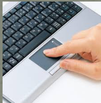
TouchPad: Pointage sur PC- Portable (Pavé Tactile)
