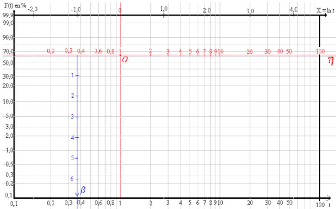
On construit tout d'abord le nuage de points  $(t_i; F(t_i))$  puis une droite d'ajustement  $D$ , on lit la valeur du paramètre  $\eta$  sur l'axe des abscisses puis on trace la parallèle  $D'$  à la droite  $D$  passant par l'origine  $O$  du repère, on lit le paramètre  $\beta$  sur l'axe  $\beta$ .
