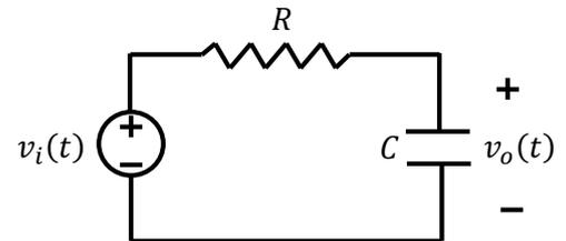
3. On excite le circuit par une tension d'entrée  $v_i(t) = 2e^{-3t}u(t)$ , déduire la tension de sortie  $v_o(t)$ . (on suppose que le condensateur est déchargé).
