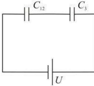
Après cette substitution, il y a 2 condensateurs dans le circuit -  $C_{12}$  et  $C_3$  branchés en série.
