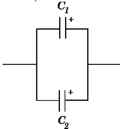
**Fig 42:** Deux condensateurs connectés en parallèle.
