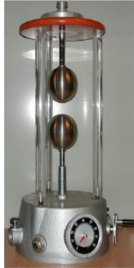
Figure.5 : Photo représente un éclateur (position verticale)
