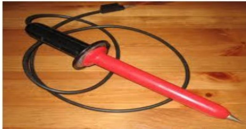
**Figure.13** : Une sonde pour mesurer la haute tension
