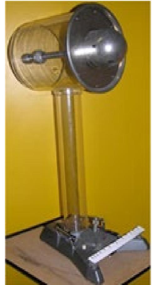
Figure.1 : Photo de voltmètre électrostatique
